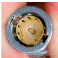
BNC Neutrik: перекося при боковом изгибе отсутствует
